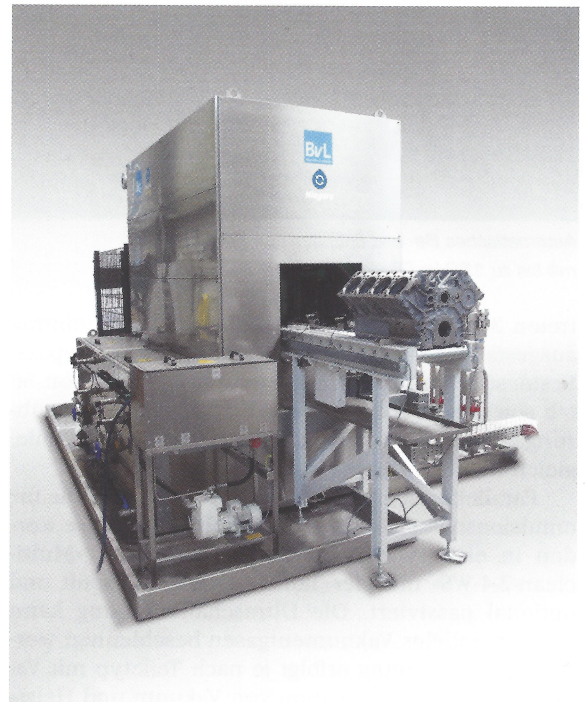
Korbwaschanlage «NiagaraDFS» mit getaktetem Durchlaufverfahren zur Optimierung der Taktzeiten.
