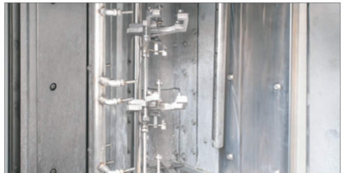
Blick in die Trocknungszone: Trocknung mit rotierendem Düsen system und leistungsstarkem Seitenkanalverdichter
