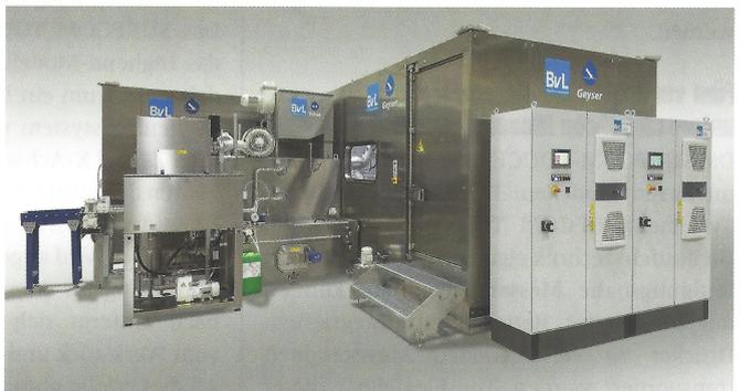
Hier wird die Geyser-Hochdruckeinheit mit einer Yukon-Durchlaufanlage kombiniert.
