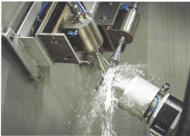
Die Hochdruckeinheit GeyserVM erzeugt einen Wasserdruck von bis zu 3000 bar, der insbesondere zum Entgraten gezielt genutzt wird.
