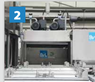
Detail externer Vakuumtrockner
